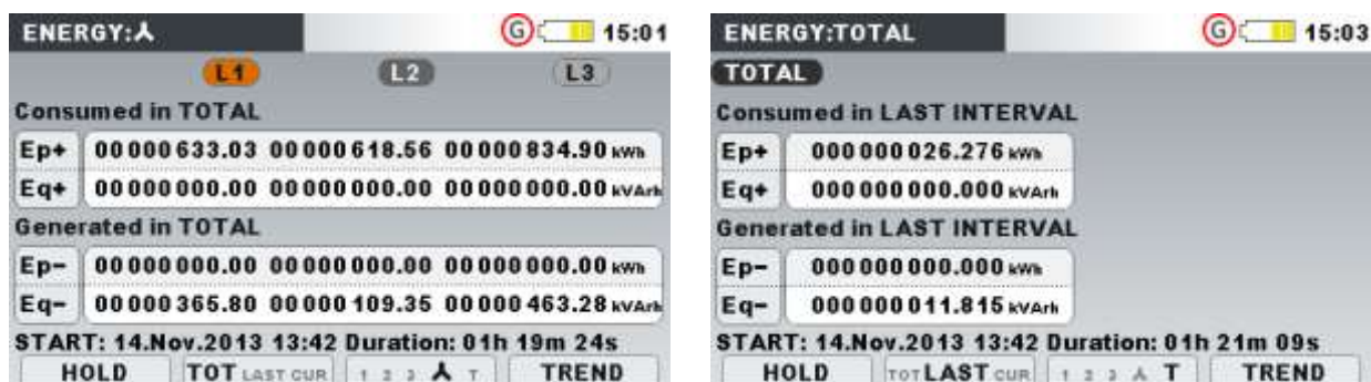
Image0.27: Ecrans des compteurs d'énergie
