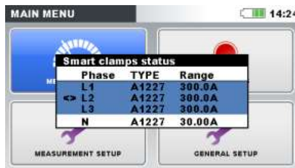
Image 0: Réglage de la reconnaissance automatique des pinces
