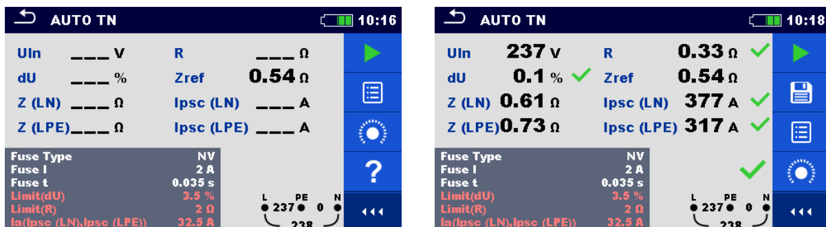
Image 8.11: Exemple de résultats de mesure AUTO TN.
