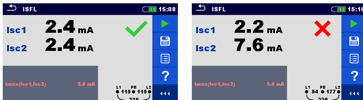
Image 7.65: Exemple de résultat de mesure de premier défaut de courant de fuite.
