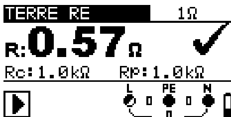
Schéma 4.35: Exemple de résultat de mesure de résistance de terre.
