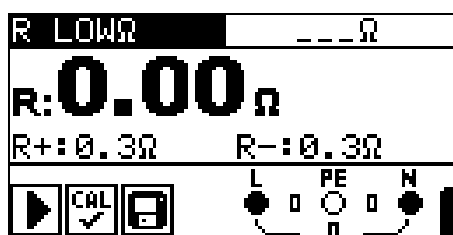
Schéma 4.10: Exemple de résultat RLOW
