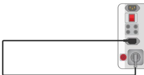
Image 6.22 : Compensation entre la prise principale de test et la prise IEC
