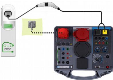
Tests de fonctionnement et de diagnostic des bornes de recharge selon EN 61851-1 et tests de sécurité électrique selon EN 60364-6.
