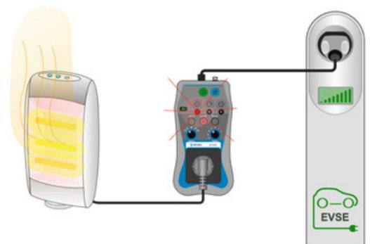
Accessoire de test des bornes de recharge pour véhicules électriques avec possibilité de raccorder une charge jusqu'à 13A
