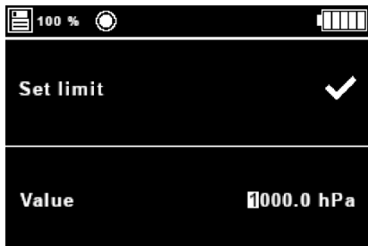
Figure 24 | Définir la valeur de l'alarme
