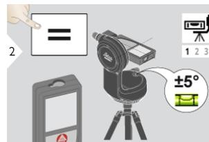
Pour pouvoir être calé, l'appareil doit se trouver dans une plage d'inclinaison de  $\pm 5^\circ$ .
