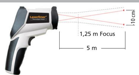
Affichage vidéo en temps réel du point de mesure avec toutes les données de mesure importantes Optique infrarouge de qualité : 50:1
