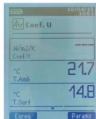
*L'appareil affiche le coefficient U, la température de surface, la température ambiante et la température extérieure.*
