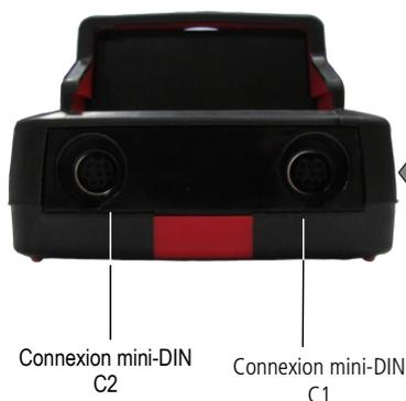
Les sondes d'hygrométrie et de température Pt100 sont à brancher sur les connexions Mini-din C1 et/ou C2
