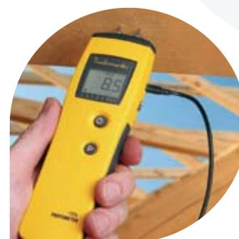
La sonde de température (accessoire en option) permet d'obtenir automatiquement un taux d'humidité corrigé.
