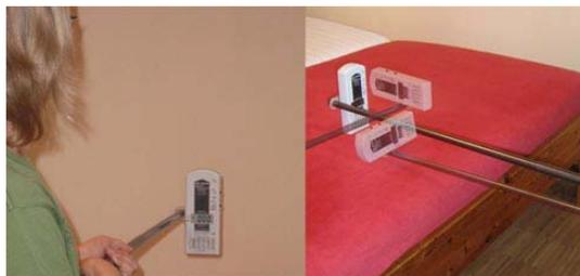
detentor dieléctrico (p. ej. el PM2 de Gigahertz Solutions), las mediciones efectuadas en todas las tres direcciones XYZ, y la adición vectorial de los resultados<sup>4</sup>.
