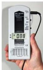
Den Klinkenstecker des beiliegenden Erdungskabels in die dafür vorgesehene Buchse  $\perp$  stecken und das Kabel an der Seite des Gehäuses nach hinten führen. Erdungskabel oder Finger dürfen nicht über die Vorderkante des Messgeräts hinausragen (verfälscht den Messwert!).
