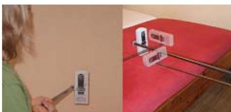
on a besoin de beaucoup de savoir-faire, ainsi que d'une perchette isolante spéciale (p. ex. la PM2 de Gigahertz Solutions). De plus il faut effectuer les mesures dans les trois directions XYZ
