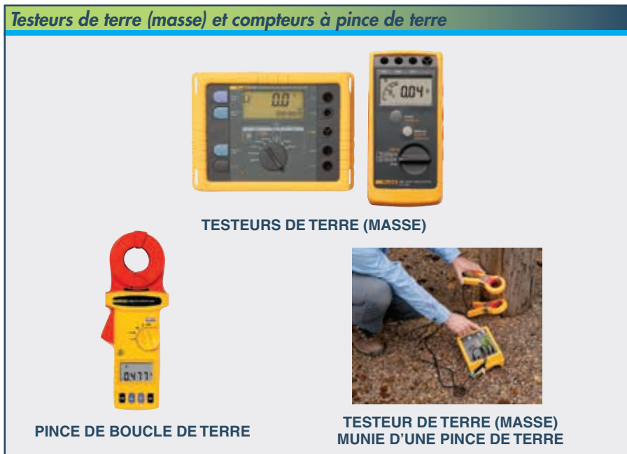
Figure 1-1. Les tests d'un système de mise à la terre sont effectués pendant et après l'installation du système à l'aide de testeurs de terre (masse) et de pinces multimètres de terre.
