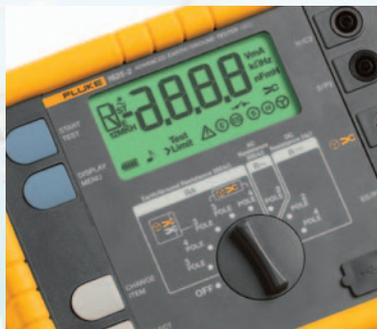
Utilisez le Fluke 1625-2 pour déterminer l'état de vos systèmes de mise à la terre.
