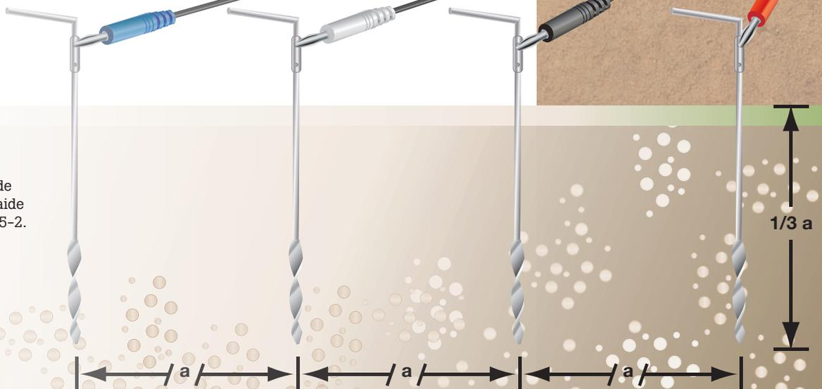
Installation pour le test de résistivité du terrain à l'aide du Fluke 1623-2 ou 1625-2.
