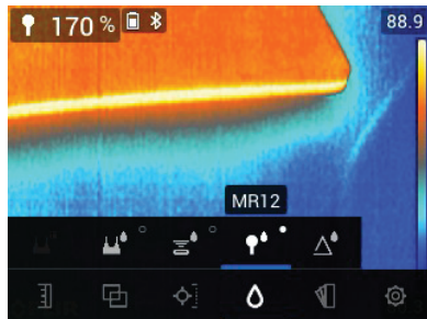
Figure 7.12 Sélection du mode MR12 (sonde d'humidité à bille en option)
