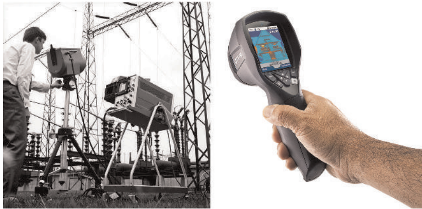
Figure 12.2 À GAUCHE : Thermovision modèle 661 de 1969. La caméra pesait environ 25 kg, l'oscilloscope 20 kg et le trépied 15 kg. L'opérateur a également utilisé un groupe électrogène de 220 V CA et un récipient de 10 l d'azote liquide. A gauche de l'oscilloscope, on distingue le Polaroid (6 kg). A DROITE : FLIR i7 de 2012. Poids : 0,34 kg, batterie comprise.
