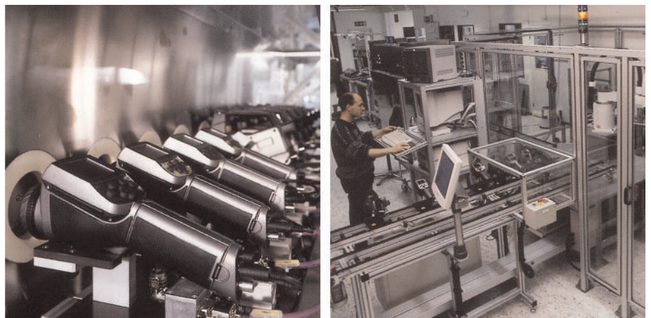
Figure 12.5 GAUCHE : Test de caméras infrarouge en chambre climatique ; DROITE : Robot utilisé pour le test et l'étalonnage des caméras
