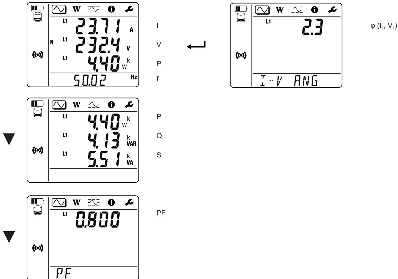
Si le capteur de courant n'est pas détecté, toutes les grandeurs qui dépendent du courant (courant, angle, puissances, PF) ne sont pas définies (affichage de - - - -).
