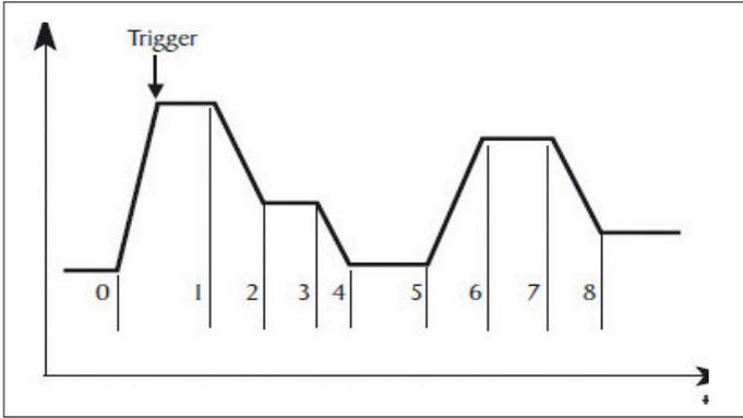
Le mode LIST est dédié aux tests qui nécessitent des séquences complexes de changement de paramètres en mode courant constant (CC). 7 groupes de fichiers LIST peuvent être sauvegardés et exécutés, chaque fichier ayant un maximum de 84 pas, avec une durée minimale de 20µs. Le déclenchement peut être interne ou externe.
