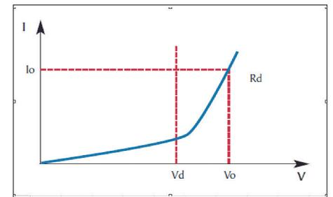
La série BK8600 dispose d'une fonction unique en mode CR (résistance constante): cette fonction simule la courbe tension/courant d'une LED et permet ainsi de tester les dispositifs de pilotage de LED.
