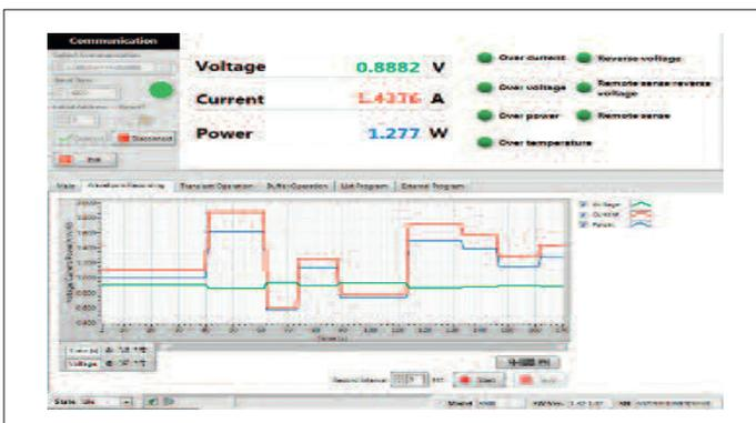
Le logiciel d'application sur PC permet l'émulation de la face avant ainsi que la programmation ou le transfert de données sans avoir à programmer. Il permet aussi de créer sans limite les fichiers utilisés dans le mode LIST, ceux-ci étant sauvegardés sur votre ordinateur.
