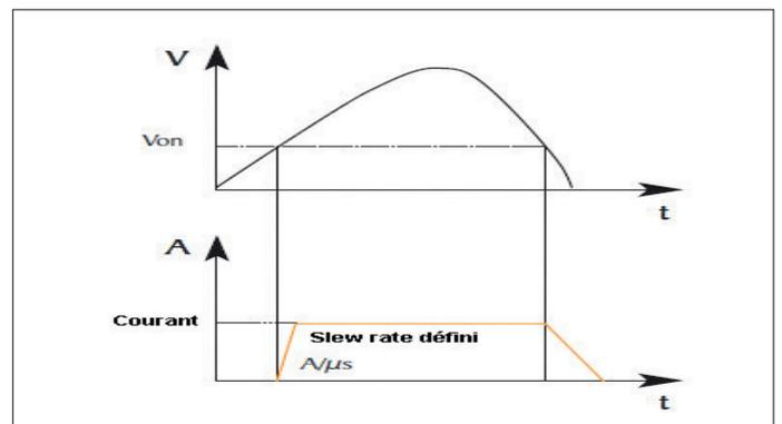
Cette fonction est très utile pour le test des alimentations et des batteries: elle permet de mettre en fonctionnement la sortie de la charge en fonction de la tension présente à ses bornes.
