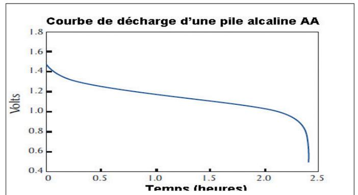
La série BK8600 est équipée d'une fonction permettant de calculer la capacité d'une batterie en utilisant le principe de décharge à courant constant. Ainsi, tous les types de batteries et piles peuvent être testés facilement. L'utilisateur définit les conditions du test: tension d'arrêt, capacité, ...
