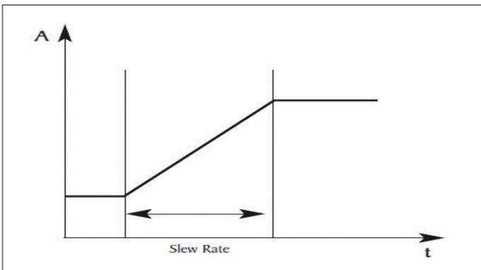
Cette caractéristique est aussi très utile pour les tests de réponse transitoire sur les alimentations. Le temps de transition est réglable de 0,001A/ms à 2,5A/µs suivant le modèle.
