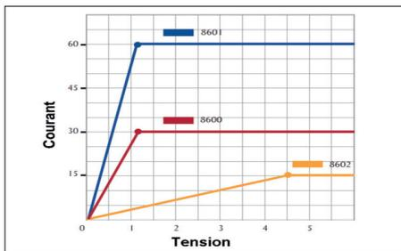
La série BK8600 permet de fonctionner avec des tensions aussi basses que 1,1V au courant nominal de la charge (suivant modèles). Cette caractéristique permet d'utiliser la charge électronique dans des applications telles que le test de piles à combustibles ou le test de cellules solaires.
