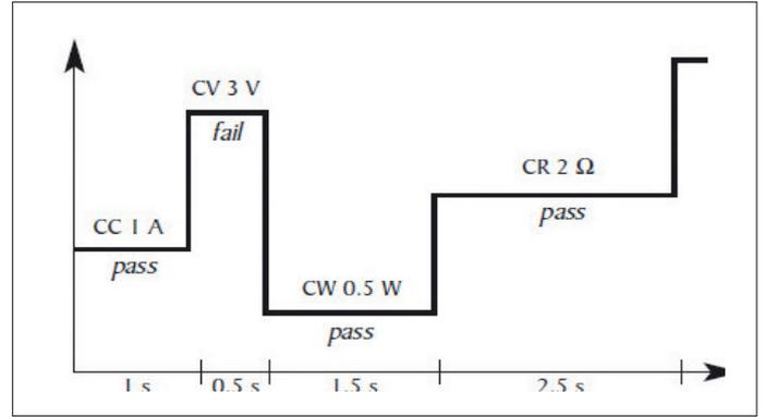
La série BK8600 permet de générer des séquences pour les tests automatisés: 100 séquences différentes peuvent être enchainées, chaque séquence pouvant avoir des paramètres de fonctionnement différents. Des limites hautes et basses peuvent être définies et l'information "pass/fail" (bon/mauvais) transmise à l'utilisateur. Ce mode est très utile pour les tests d'alimentations.
