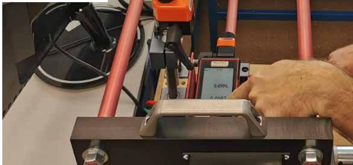
Ici, un télémètre sur le banc d'étalonnage pour s'assurer de l'exactitude de sa mesure. Ci-contre, cet appareil permet de vérifier la conformité des différents contrôleurs électriques existant sur le marché. En bas, petit aperçu du laboratoire de Testoon.
