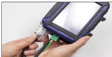
Ill. 59: Retirer le piège à condensat de l'appareil
