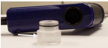
III. 58: Anneau d'étanchéité du bouchon en plexiglass placé sur la poignée de la sonde
