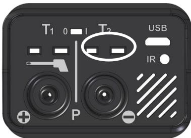
III. 14: Les prises de raccord pour le capteur de température d'air ambiant sont repérées par un cercle.
