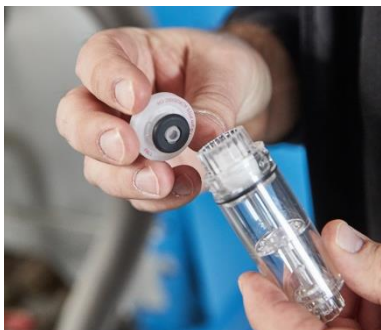
Ill. 63: Le filtre d'arrêt d'eau est inséré sur le porte-filtre
