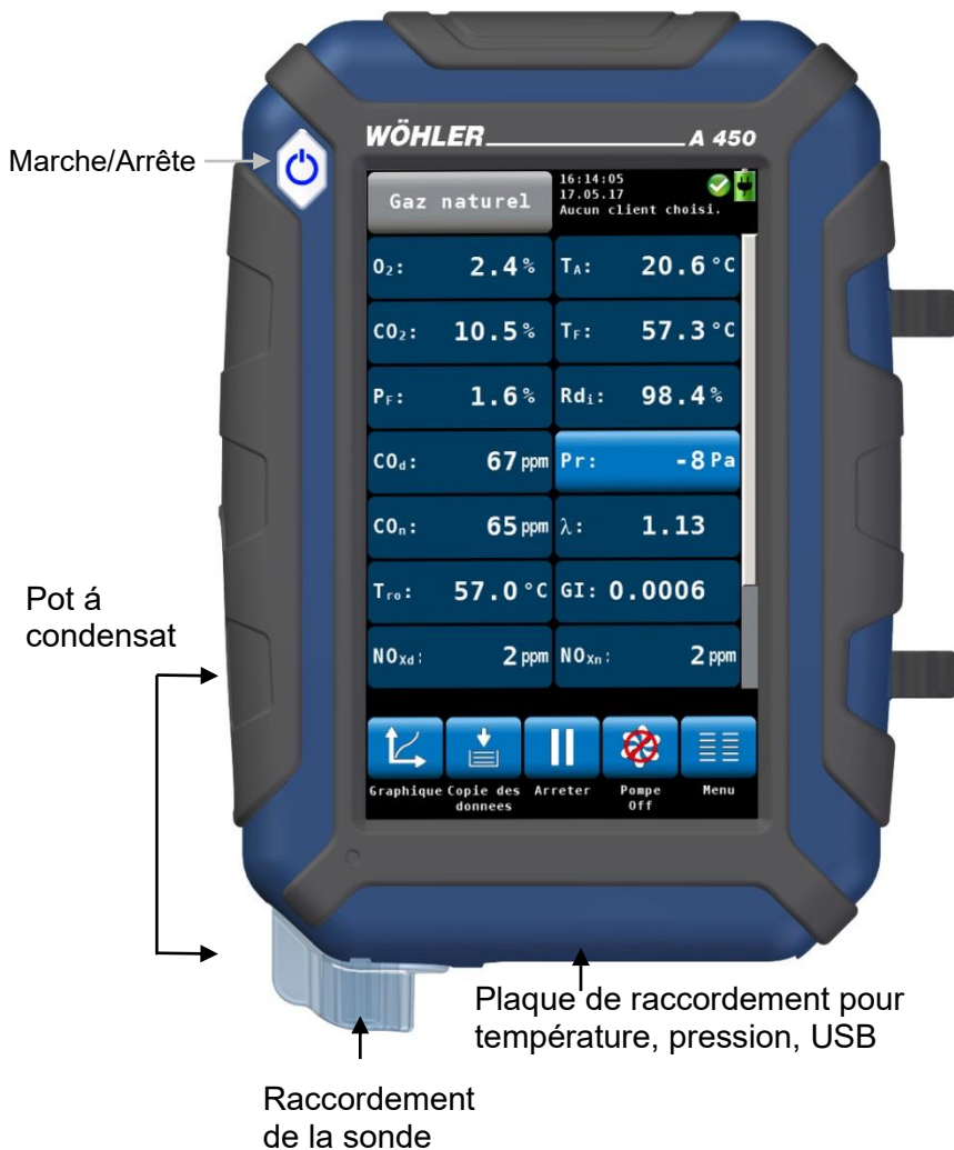
III. 2: Parties de l'analyseur vue avant
