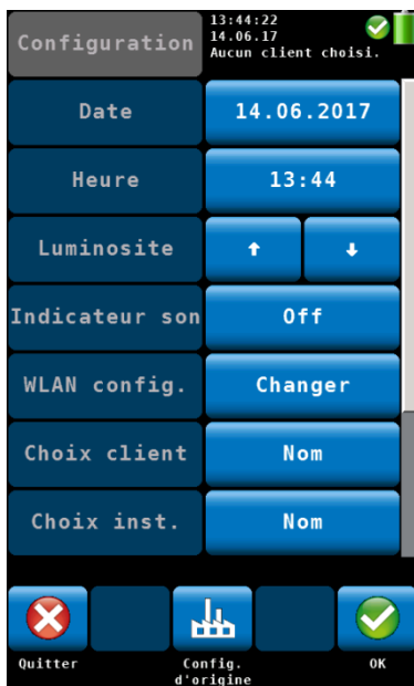
Ill. 47: Menu Configuration : la barre de défilement indique que plusieurs sous-points sont disponibles.
