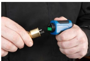
III. 10: Insertion de la sonde enfichable
