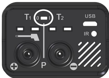
Ill. 6: Interrupteur de la batterie à droite: Batterie activée Interrupteur de verrouillage à gauche : Batterie verrouillée
