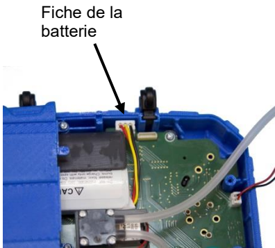
Ill. 73: Batterie Wöhler A 450 dans l'adaptateur noir, les cellules sont retirées, la fiche du capteur O 2 et le tuyau de raccordement de gaz sont encore branchés.
