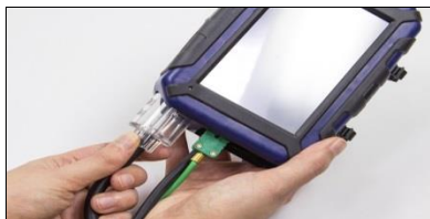
Ill. 59: Retirer le piège à condensat de l'appareil
