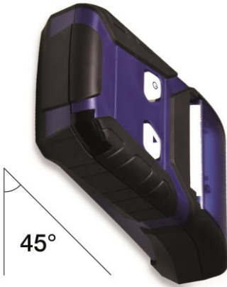
Ill. 25: Position de l'imprimante pendant la transmission des données de l'analyseur à l'imprimante
