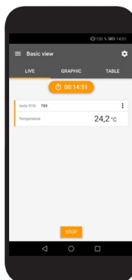
Grâce à l'App testo Smart gratuite, votre Smartphone devient l'écran du testo 915i. Aussi bien la commande du Smart Probe que l'affichage des valeurs de mesure se font sans fil via Bluetooth® sur votre Smartphone – indépendamment du lieu de mesure. En outre, vous pouvez créer des protocoles de mesure dans l'App, y ajouter des photos et commentaires et les envoyer confortablement par e-mail.
