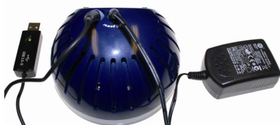
Fig. 5: Connexion du bloc d'alimentation électrique y câble USB au revers de l'appareil
