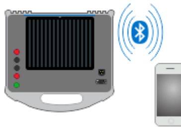
Image 5.5 : Connexion de l'appareil Euro Z 800 V au logiciel aMESM
