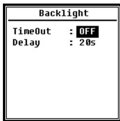
Le rétroéclairage du sonomètre est éteint automatiquement afin de limiter la consommation de l'électricité et d'économiser les piles.
