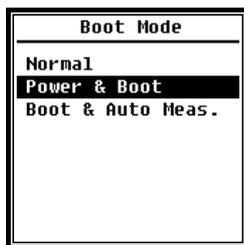
Dans le menu du **Mode lancement**, vous pouvez sélectionner le mode **Normal** (Normal), **Power & Boot** (Allumer et Lancer) et **Boot & Auto Meas** à l'aide des touches directionnelles <▲> et <▼>. (Allumer et mesures automatiques)
