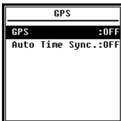
Dans le menu **GPS** vous pouvez activer et désactiver l'option **GPS** et **Auto Time Sync** (Synchronisation automatique du temps). Si l'option GPS est désactivée, le module interne GPS est éteint. Après avoir activé l'option **Auto Time Sync** (Synchronisation automatique du temps), l'horloge système du sonomètre est synchronisé avec le temps GPS.
