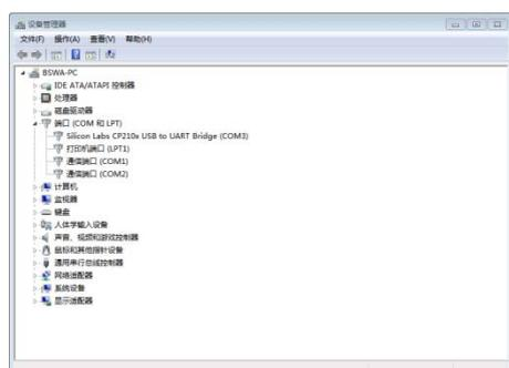
Après l'installation du pilote, connectez le sonomètre à l'ordinateur. Dans le Gestionnaire de périphériques vous allez trouver un nouvel appareil **Silicon Labs CP210x USB to UART Bridge (COMx)**.
