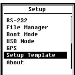
Le menu **Configuration** comprend la configuration de la fonction de base et de l'affichage conditionnel. À l'aide des touches directionnelles <▲> et <▼> vous pouvez sélectionner une option et entrer dans le niveau suivant du menu en appuyant sur la touche
