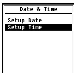
L'horloge du temps réel RTC du sonomètre dans le menu **Date & Time** (Date et heure). Pour sélectionner, appuyez sur les touches directionnelles <▲> et <▼>.
