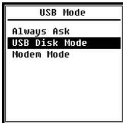
Dans le menu **USB Mode** (Mode USB) vous pouvez configurer le mode de travail du sonomètre relié à l'ordinateur par câble USB. Vous disposez de : **Always Ask** (Demandez toujours), **USB Disk Mode** (Disque USB) i **Modem Mode** (Mode modem).
