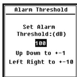
Quand les résultats de mesure des profils 1 à 3 dépassent le **Seuil d'alarme**, une diode rouge LED s'allumera au-dessus de la touche <POWER>. Le seuil d'alarme peut être réglé entre 20 dB et 200 dB. À l'aide des touches directionnelles <▲> et <▼> vous pouvez augmenter ou baisser le seuil d'alarme de 1 dB. À l'aide des touches directionnelles <◀> et <▶> vous pouvez augmenter ou baisser le réglage de 10 dB.
