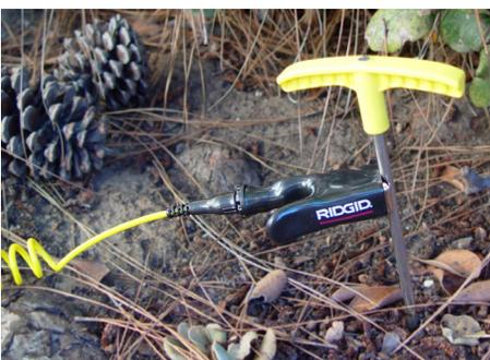
Une fois que les pinces de câbles du transmetteur sont attachées à la ligne cible et au piquet de mise à la terre, un circuit d'acheminement du signal est créé. Ce circuit permet la circulation du courant et une stimulation de la ligne cible.
