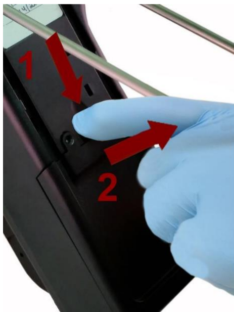
Etape 3 – Abaissez le loquet tout en tirant du couvercle du compartiment à piles
