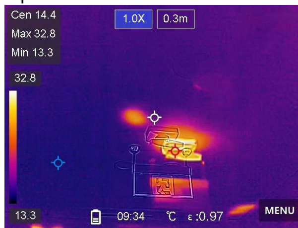
Figure 3-2 Réglage de la correction de parallaxe
