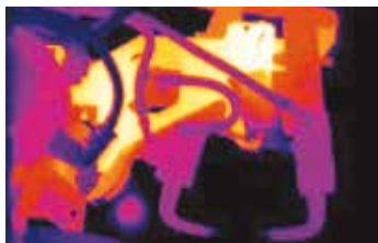
Point chaud sur un robot de soudage
