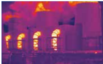
Déperdition thermique par un défaut d'isolation d'une conduite de vapeur.
