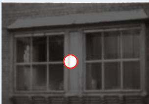
Ce que voit un thermomètre IR.
