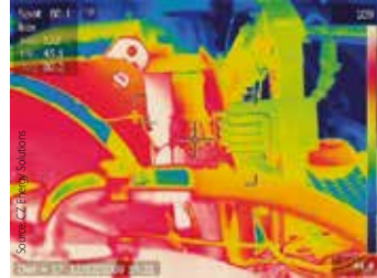
Images visible et thermique de la transmission d'une éolienne. Cette inspection a été effectuée à une hauteur d'environ 50 mètres.
