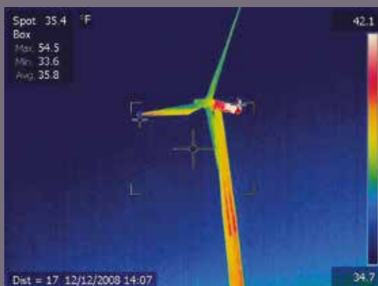
Image thermique d'une éolienne, prise au niveau du sol
