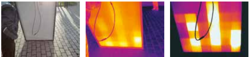
Ces images de l'arrière du même panneau solaire comportent beaucoup moins de reflets qu'à l'avant ; les mesures de température gagnent donc en exactitude.
