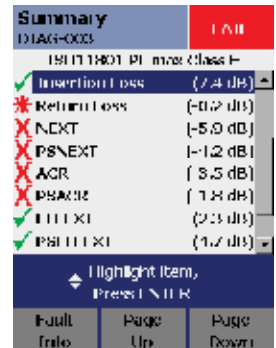
Figure 4 : A la fin de l'autotest, l'écran du testeur affiche la liste des paramètres de test mesurés pour le test sélectionné. Les paramètres de test marqués d'une croix rouge présentent des résultats non conformes. Le testeur affiche également entre parenthèses la plus mauvaise marge pour chaque paramètre du côté droit de l'écran.
