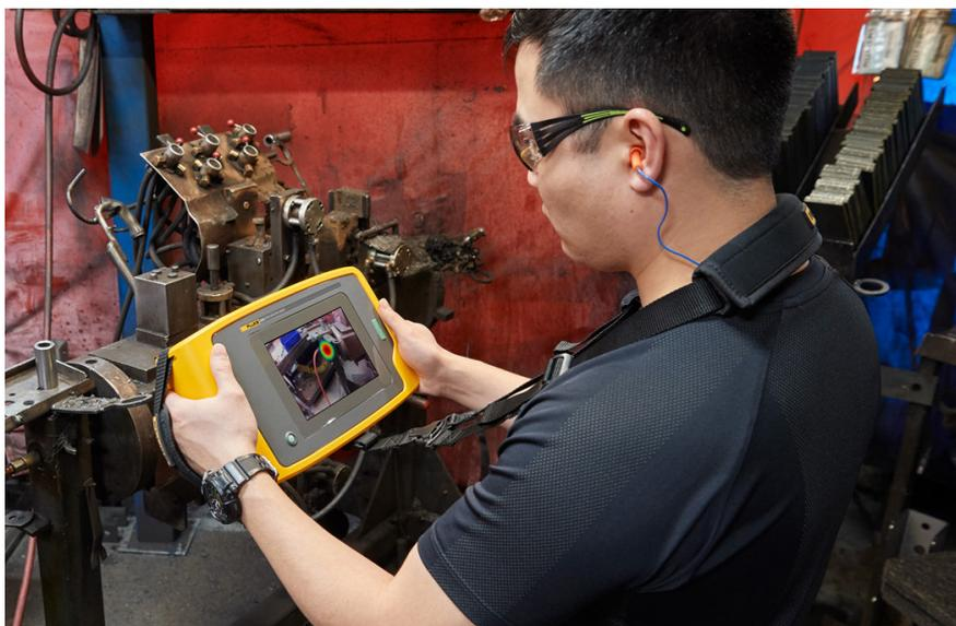
localise exactement la fuite. Les résultats sont affichés sur l'écran LCD 7" sous forme d'image fixe ou de vidéo en temps réel. La caméra acoustique ii900 peut enregistrer jusqu'à 999 fichiers image ou 20 fichiers vidéo à des fins de documentation ou de conformité.
