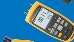
**L'anémomètre Fluke 922** permet de réaliser facilement des mesures du débit de l'air en combinant la pression différentielle, le débit et la vitesse de l'air en un appareil résistant unique.
