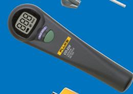
**Le testeur de monoxyde de carbone CO-220** mesure les niveaux de monoxyde de carbone dans les environnements industriels et les bâtiments commerciaux et résidentiels où il existe un risque d'accumulation de gaz de combustion.
