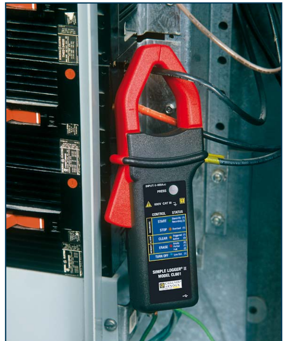
Enregistrement simple du courant sur tableau
