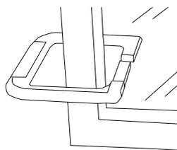
Dessutom är en optisk glastjockleksmätare integrerad. Med denna kan tjockleken på enkelglas av upp till 25 mm tjocklek bestämmas. På isolerglasenheter kan endast de åtkomliga skivorna mätas.
