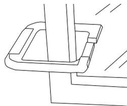
Ezenkívül egy optikai üveg vastagságmérő is integrálva van. Ezzel 25 mm-es vastagságig meghatározható az egyrétegű üveg vastagsága. A szigetelt üvegszerkezeteknél csak a hozzáférhető üvegtáblák mérhetőek.
