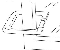
Ponadto zintegrowany jest miernik grubości szkła optycznego. Dzięki temu można określić grubość pojedynczego szkła o grubości do 25 mm. W przypadku zespołu szyb izolujących można zmierzyć tylko szyby dostępne.
