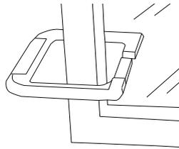
Zusätzlich ist ein optischer Glasdickenmesser integriert. Mit diesem kann die Dicke von Einfachgläsern bis 25 mm Dicke bestimmt werden. Bei Isolierglaseinheiten können nur die zugänglichen Scheiben gemessen werden.
