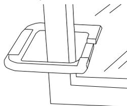
Adicionalmente, está integrado um medidor óptico de espessura de vidros. Com este dispositivo é possível determinar a espessura de vidros simples até 25 mm de espessura. Em caso de unidades de vidro de isolamento, só os vidros acessíveis podem ser medidos.
