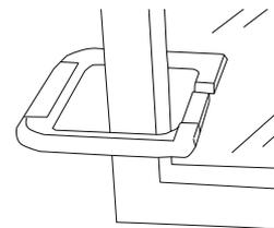
Un medidor óptico de espesores de vidrio viene integrado adicionalmente. Este dispositivo permite medir el espesor de vidrios monolíticos de hasta 25 mm. En caso de acristalamientos aislantes, se pueden medir solamente los vidrios accesibles.
