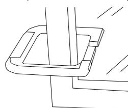
В этом детекторе дополнительно есть также оптический измеритель толщины стекла. За счет этого возможно считывать толщину отдельных стекол толщиной до 25 мм. В стеклопакете можно измерять только то стекло, к которому можно приложить прибор.
