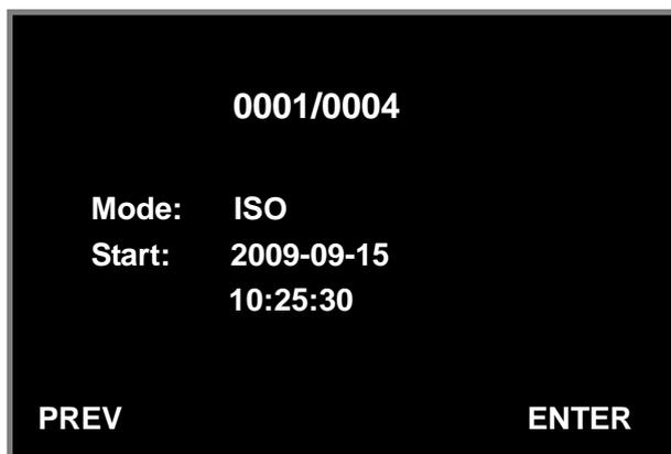
Lorsque l'option « Show Data Record » (Afficher l'enregistrement de données) est sélectionnée alors que le mode de données est défini sur ISO, les résultats du prélèvement s'affichent.
