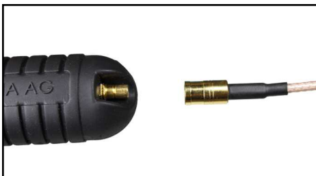
Chaque sonde possède un connecteur SMB..
