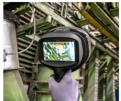
La FLIR Si2-LD détecte deux sources potentielles de fuites d'air comprimé, qui se distinguent du bruit de fond.
