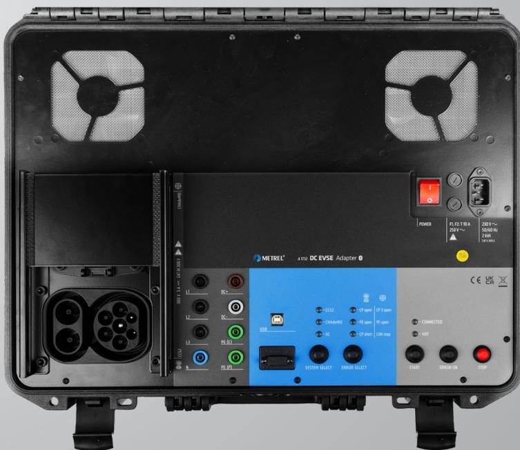
L'adaptateur A 1732 est un outil spécialisé conçu pour la sécurité électrique et les tests fonctionnels des équipements de charge de véhicules électriques (IRVE) en modes 4 (IRVE DC) et 3 (IRVE AC). Il prend en charge une variété de types de connecteurs, notamment CCS2, CHAdeMO et les prises AC de type 2, ce qui le rend très polyvalent.
