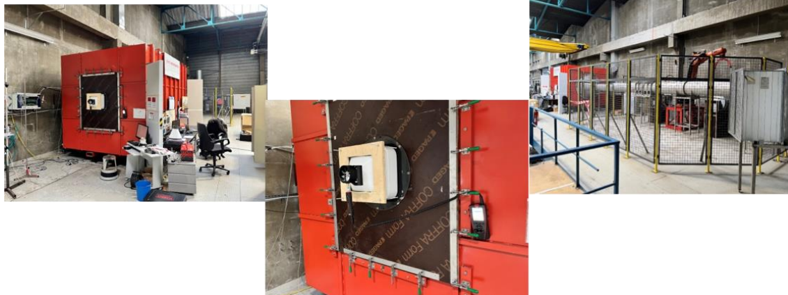
Figure 4 : Banc de débit (infiltrométrie) du Cetiati utilisé pour calibrer la mesure de débit des deux cônes
